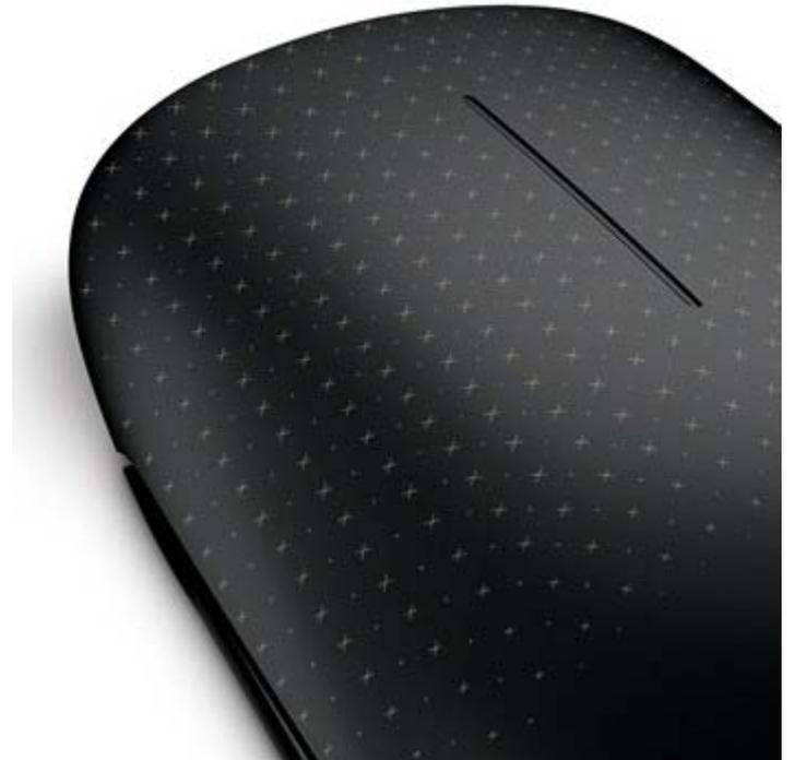
Microsoft a récemment dévoilé sa prochaine souris, entièrement tactile. Exit les boutons droite et gauche "cliquables": l'ensemble des actions s'opère par simple contact, grâce au mouvement d'un, deux ou trois doigts sur la partie supérieure de l'objet. Fonctionnant comme la Magic Mouse d'Apple, elle apporte une petite innovation dans la pratique de ce type d'instrument, s'inspirant intelligemment du fonctionnement des écrans et pavés tactiles.
