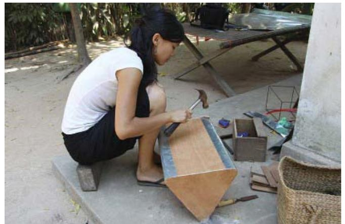
*Fabrication d'un moule en contre-plaqué et tôle de zinc.*
